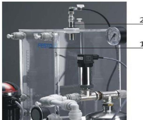
*Figure I.10: Capteur de niveau ultrasonique.*
