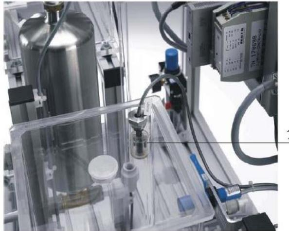
*Figure I.7: Flotteur de sécurité anti débordement.*
