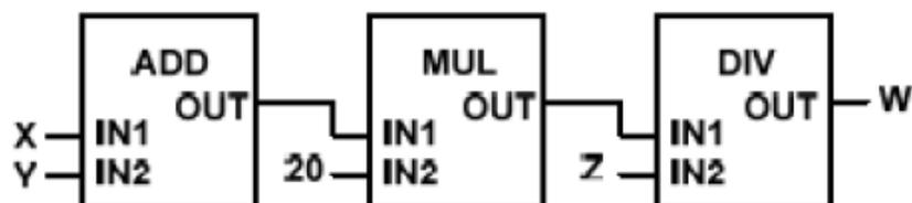
Figure II.9: Exemple d'un programme en Fonction Bloc.
