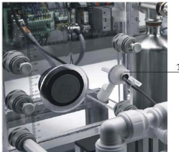
*Figure I.8: Flotteur pour la détection des seuils de remplissage.*
