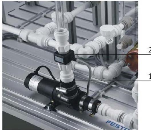
*Figure I.11: capteur de débit.*
