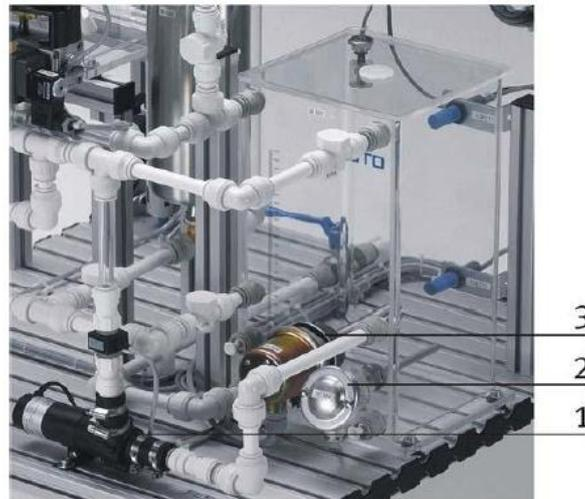
*Figure I.13: Capteur de température.*
