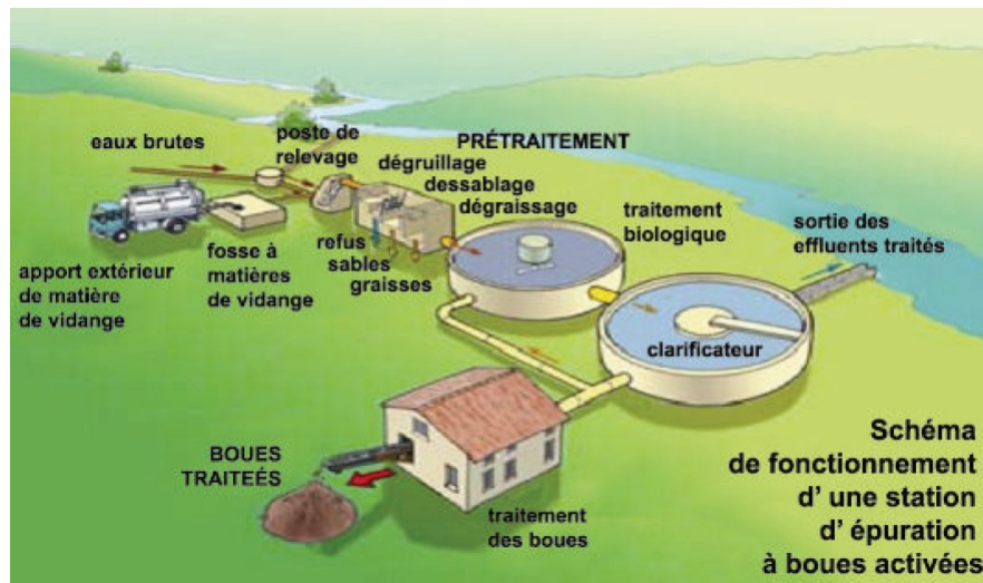
FIGURE 4.1 – Cycle de l'eau dans une station d'épuration
