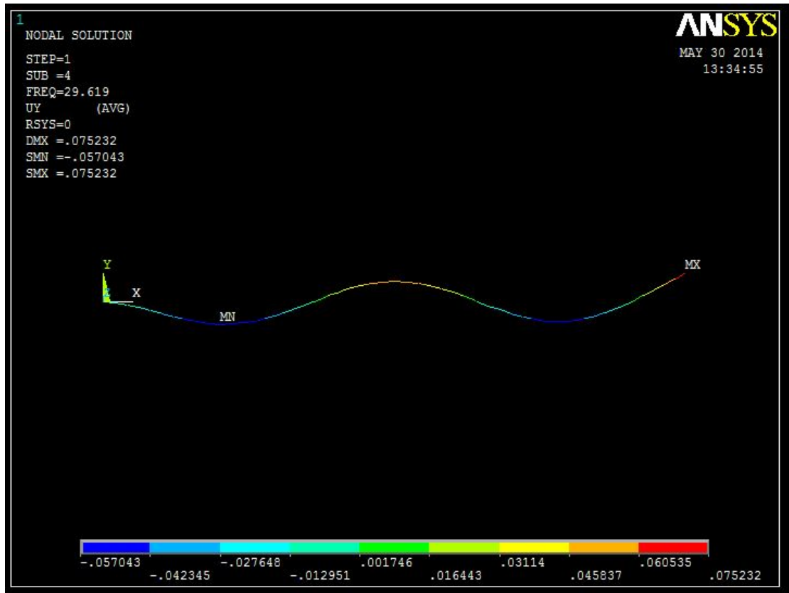
Figure 4.14 : quatrième mode de vibration libre.
