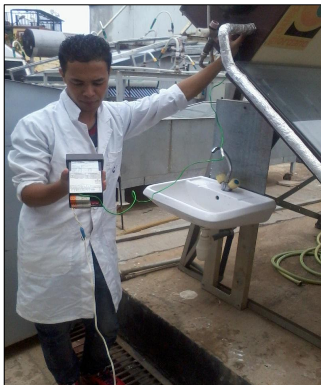
Figure V.13: Mesure de la température a la sortie du ballon/capteur
