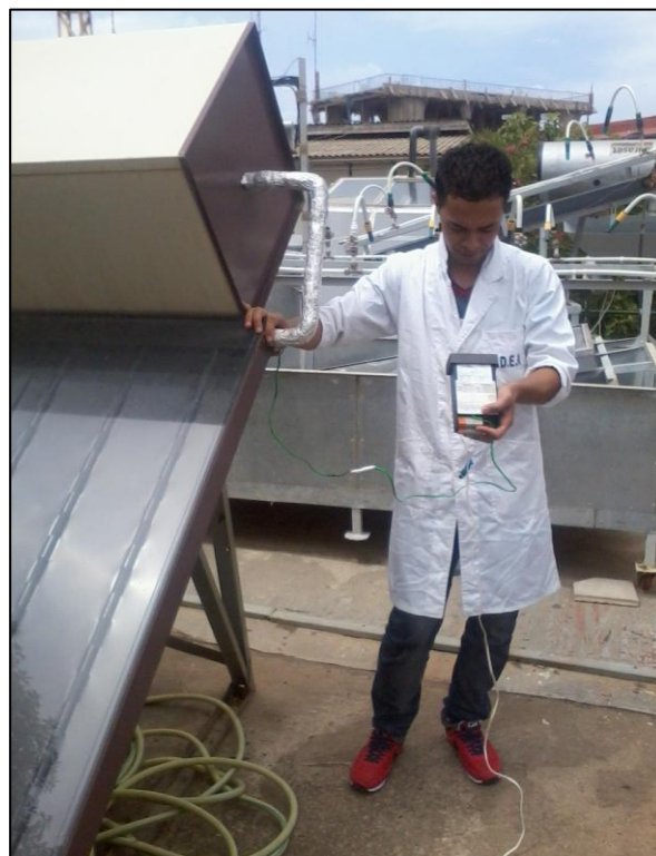
Figure V.11: Mesure de la température a la sortie du capteur
