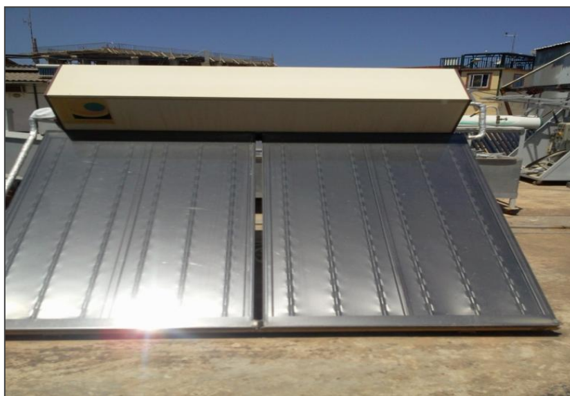
Figure V.1: Schéma du chauffe-eau solaire expérimental étudié au CDER
