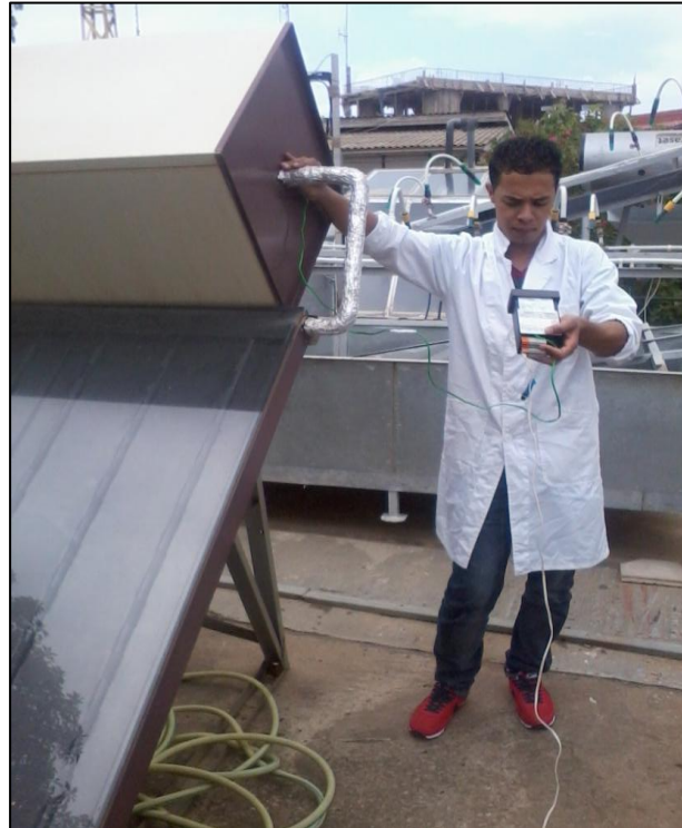
Figure V.12: Mesure de la température a l'entrée du ballon de stockage/capteur
