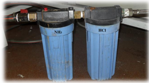
Figure 3.5 : Ensemencement du mélange air hélium par des sels d'ammonium
