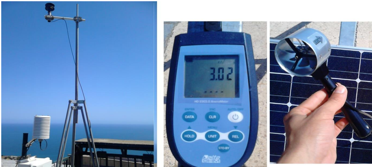
Figure5.3 : Anémomètre pour mesurer la vitesse et la direction de vent
