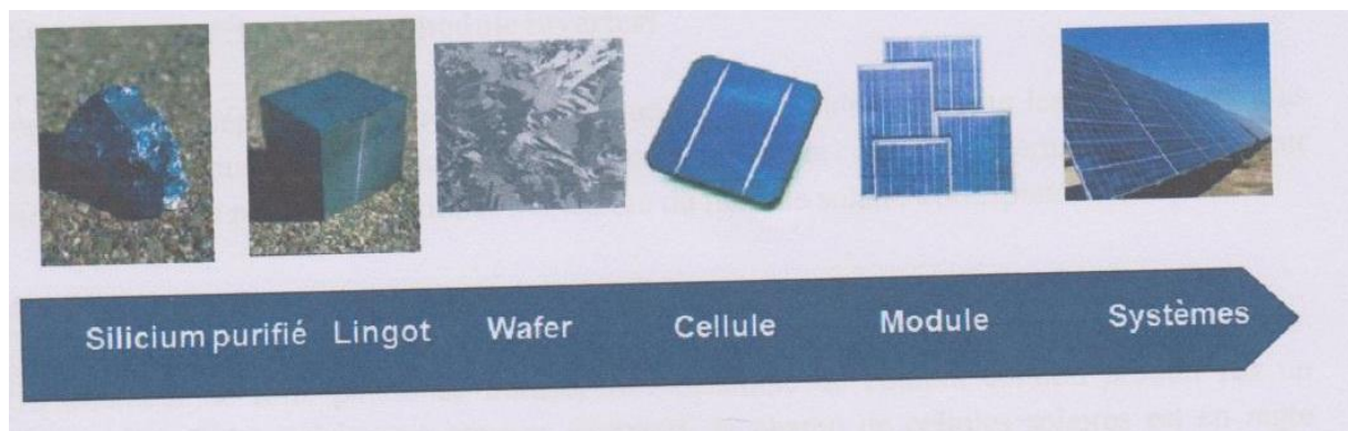
Figure2.9: différentes étapes de fabrication de module PV
