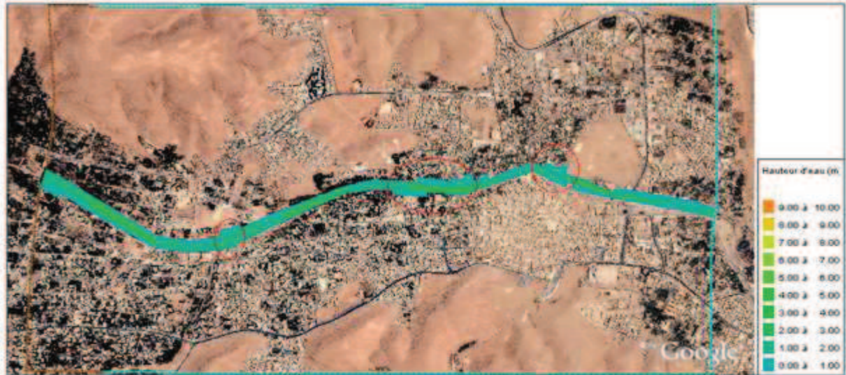
Figure V.12 : Hauteur d'eau pour t = 4875 s.
