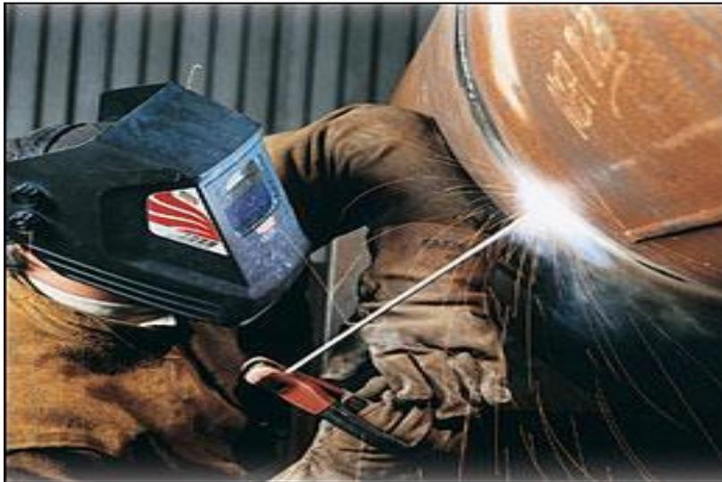
**Figure 4: soudage à l'arc enrobé**
