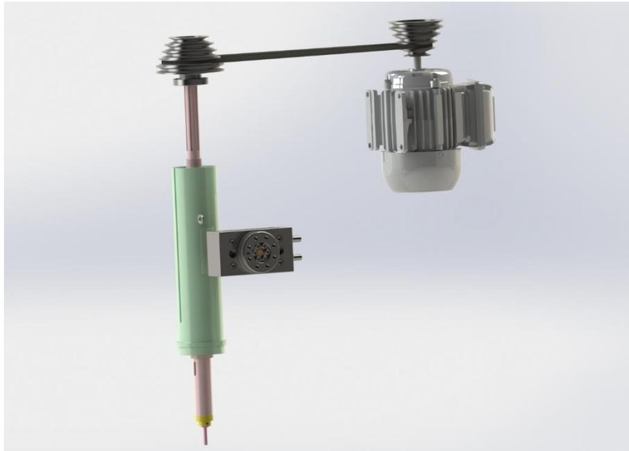
**Figure 46: modification du mouvement de translation de la perceuse**
