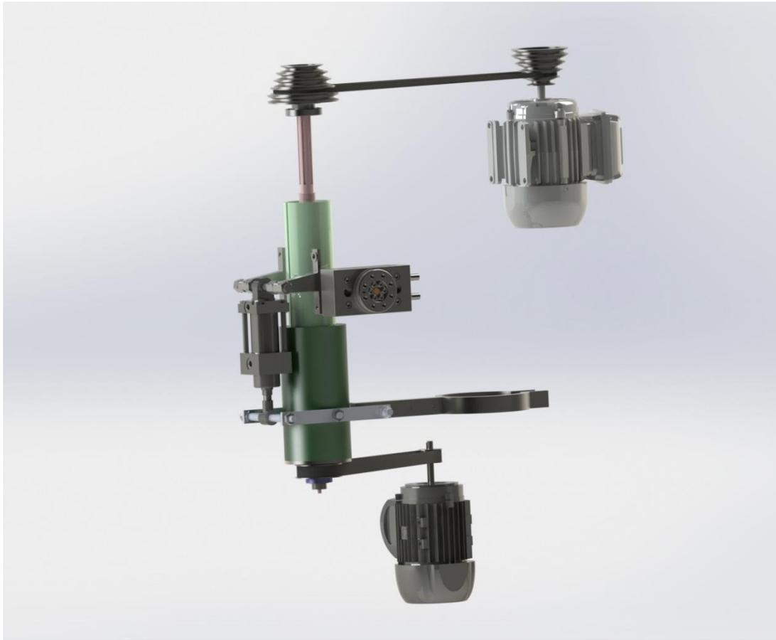
**Figure 48: organes de la machine de FSSW**
