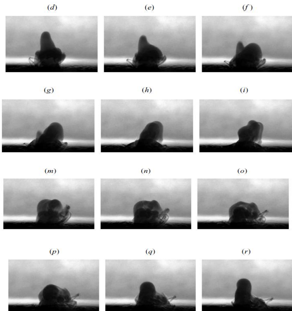
Figure 1.6 : Visualisation du ‘bobbing laminaire’ à Re = 246 et Fr = 1.5 , avec U = 5.4 cm/s, D = 4.8 mm et \Delta\rho/\rho = 0.033 , Williamson et al [15].
