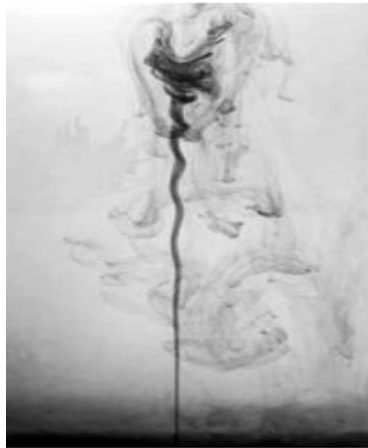
Figure 1.7: Visualisation de fontaine à F_r = 5515 et Re = 210 avec U=27.6\text{cm}\cdot\text{s}^{-1} , D=0.76\text{mm} \Delta\rho/\rho =0.00186 , Williamson et al [15].
