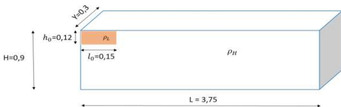
Fig. 4.9: G_4 , modèle géométrique adapté pour les simulations FDS \varepsilon = 0,01
