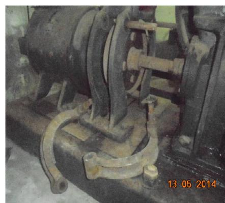
Figure II.22 Sabots de freinages démontés
