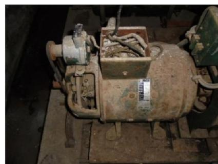
Figure II.26 : moteur à courant continu
