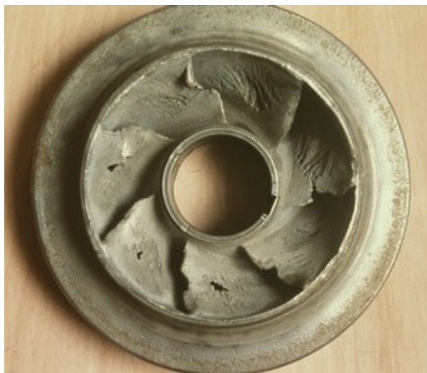
Figure 4.15. Effet des cavitations sur la roue de la pompe centrifuge.
