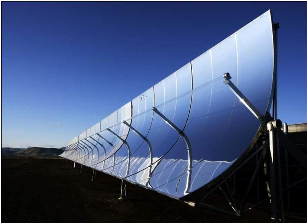
*Figure I.6. Collecteur cylindro-parabolique.*
