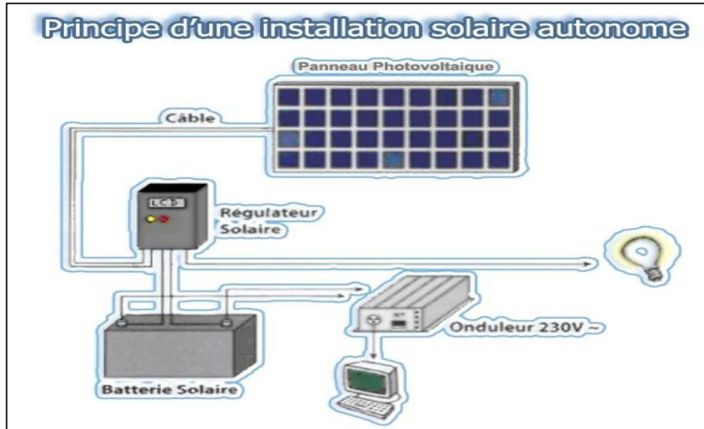
Figure I.1. Installation solaire photovoltaïque.
