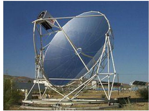
Figure I.3: Miroir parabolique concentrateur.
