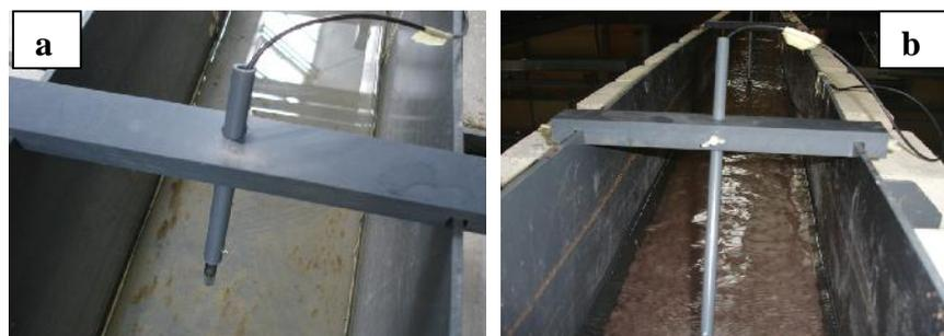
Figure 3.7 : Disposition des sondes *US* dans le canal  $6.00\text{m} \times 0.25\text{m}$
