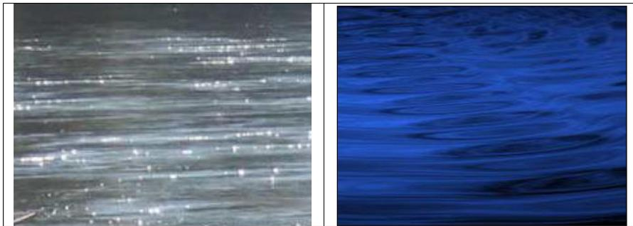
Figure 1.8 : Instabilité de la surface libre en écoulement permanent
