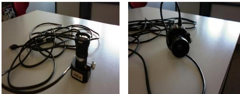
Figure 4.5 : Caméra numérique Smx-155.exe, 1.3 Méga Pixel
