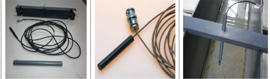
Figure 1.2 : Transducteur utilisé dans les essais *UVP*
