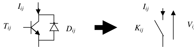
Fig.II-2 : Interrupteur équivalent à la paire transistor-diode.
