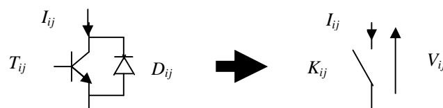
Fig.I-5 : Interrupteur équivalent à la paire transistor-diode.
