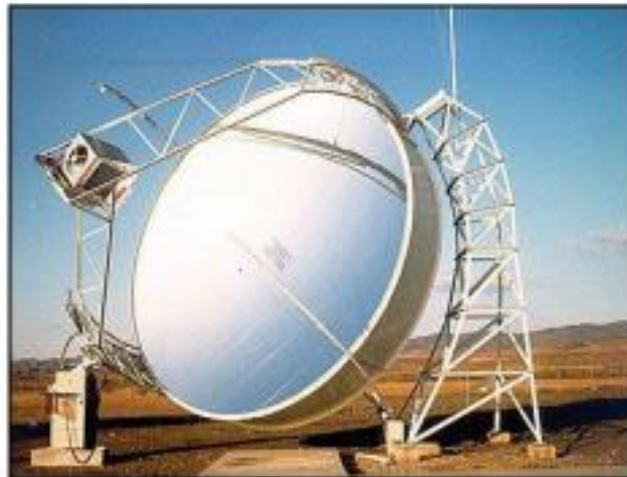
Fig (1.14) Capteur parabolique avec moteur Stirling [12]
