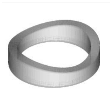
Fig 4.7 Ondulations sur la face du rotor
