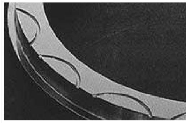
Fig 4.8 Face rainurée d'une garniture thermohydrodynamique Burgmann
