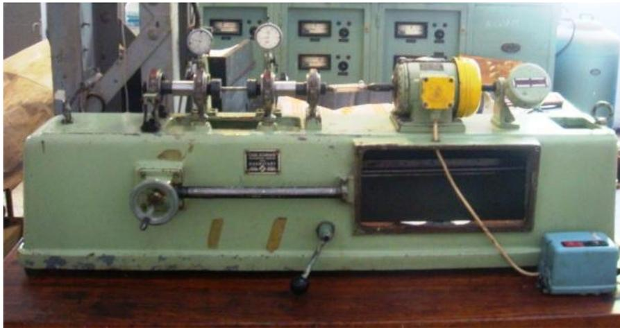
Figure.IV.21: Machine de flexion rotative « SCHENCK ».
