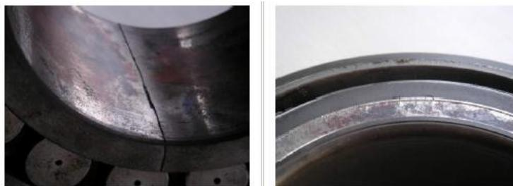
**Figure.I.16:** Corrosion de contact suite à une rupture de bague.
