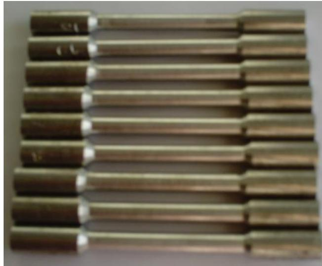
**Figure.IV.7 :** Eprouvettes en Aluminium après traitement.
