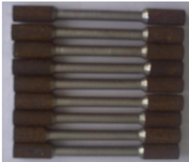
**Figure.IV.6:** Epreuves en acier avant traitement
