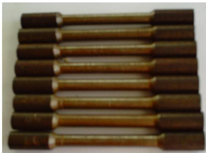
**Figure.IV.8 :** Eprouvettes d'acier après le traitement.
