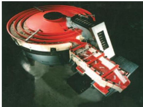
Figure.III.5 : Vibrateur circulaire spiral type Rotomatic.
