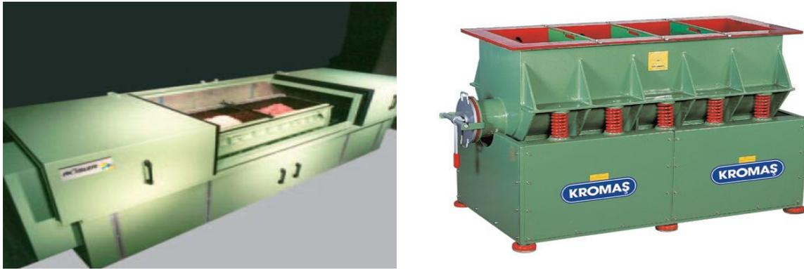
**Figure.III.9 :** Deux types des vibrateurs linéaires.
