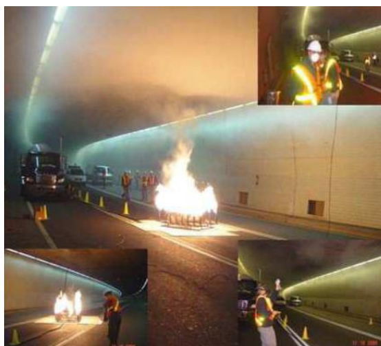
Fig. 1.9 Les essais d'incendie faits au tunnel de L.H. la fontaine (Canada).
