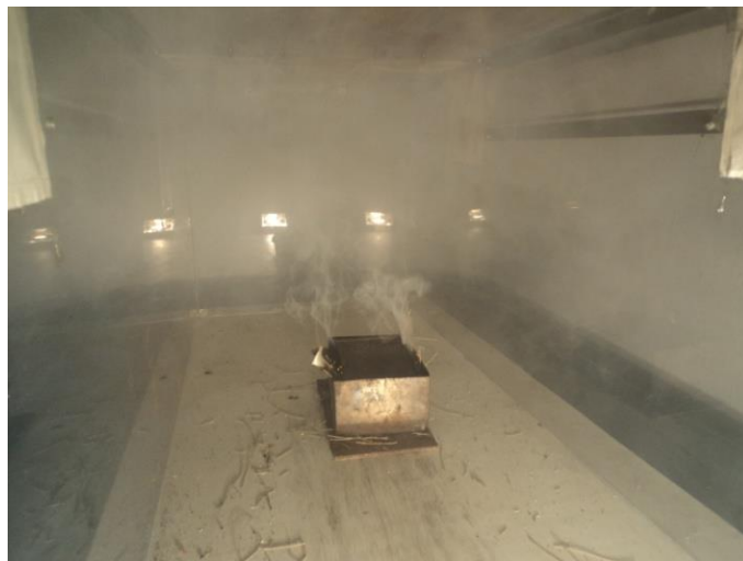
Fig.3.6 Bac, source de fumées.
