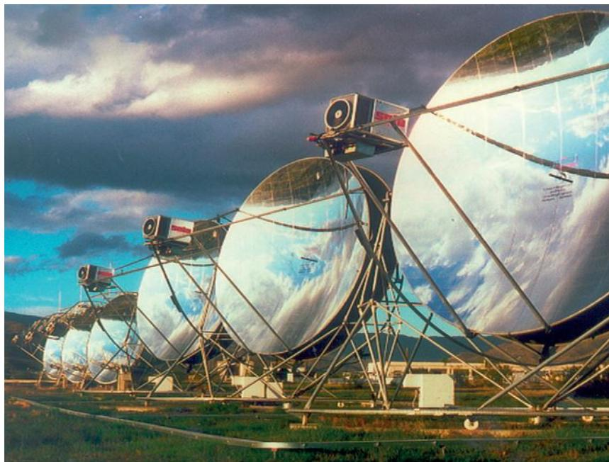
Figure 19 : Capteur parabolique avec moteur Stirling
