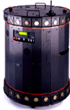
FIGURE 1.6 – Représentation d'un robot mobile omnidirectionnel [4]
