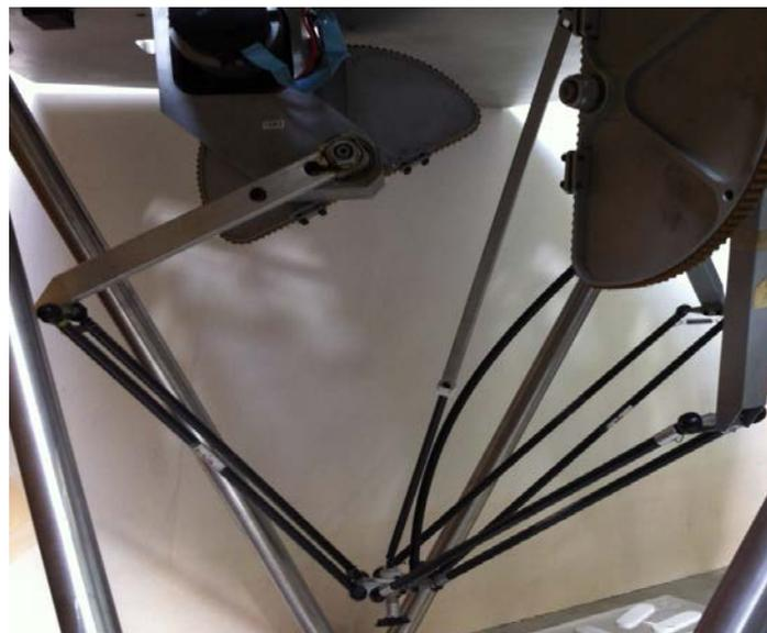
Figure 1.7 Le premier robot Delta développé à base d'engrenage [Cla3]
