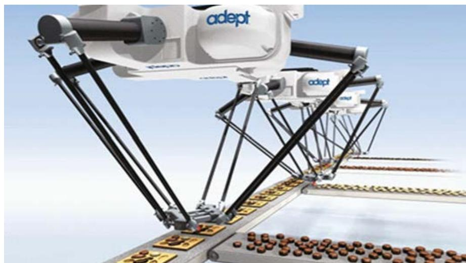
Figure 1.13 Les robots Adept Quattro pour la prise et dépose des chocolats (Adept) [Bri]
