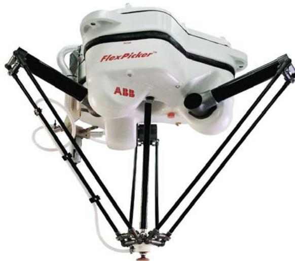
Figure 1.10 FlexPicker de chez ABB (version industrielle du robot Delta) [Cor]
