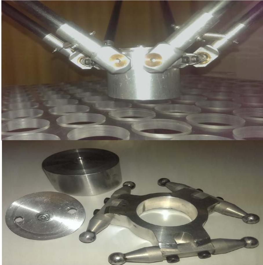
Figure 5.20 La nacelle du robot Delta avec une masse additionnelle de 150g
