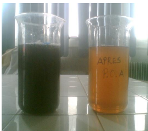
Figure 30 : Photo de la transformation du lixiviat brut (à gauche) en un lixiviat épuré (à droite) après traitement par POA.
