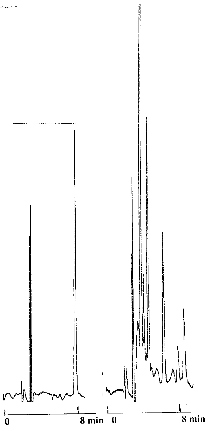
Figure n° 26 : chromatogrammes de : (A) solution étalon de deltaméthrine à 2 µg/ml, (B) : échantillon de pomme de terre. Mêmes conditions chromatographiques que figure n° 25.
