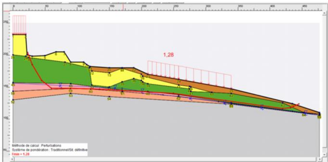
Figure A 6.8 - Coefficient de sécurité F_s pour un rabattement moyen de la nappe de 8,5 m (avec séisme et surcharges).
