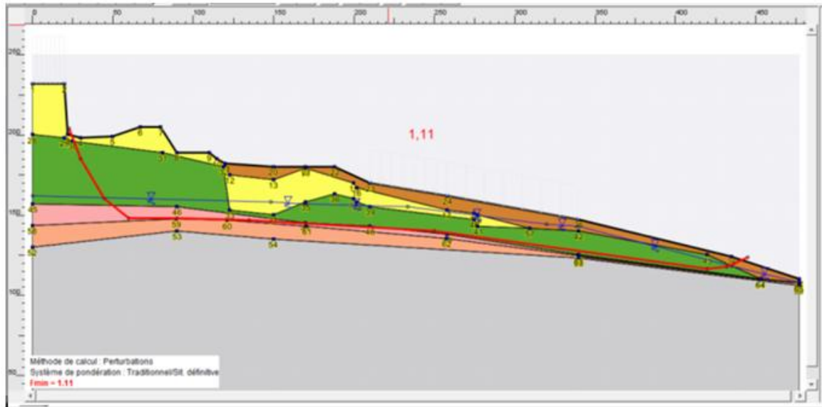
Figure A 6.13 - Coefficient de sécurité F_s pour un rabattement moyen de la nappe de 4,5 m (avec séisme et sans surcharges).
