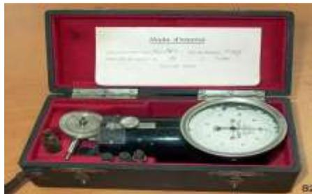
**Figure II.15 :** Tachymètre pour mesurer la vitesse de rotation
