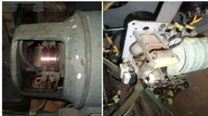
**Figure II.9 :** Collecteur du moteur à courant continu (à gauche) contacteur du dispositif de protection du moteur asynchrone (à droite)
