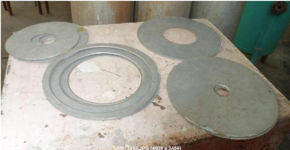
**Figure II.16 :** Diaphragmes de différents diamètres utilisés pour le réglage du débit d'air
