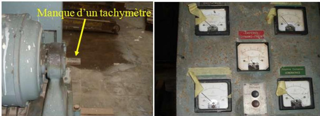
**Figure II.5 :** Etat de l'instrumentation sur le banc d'essai
