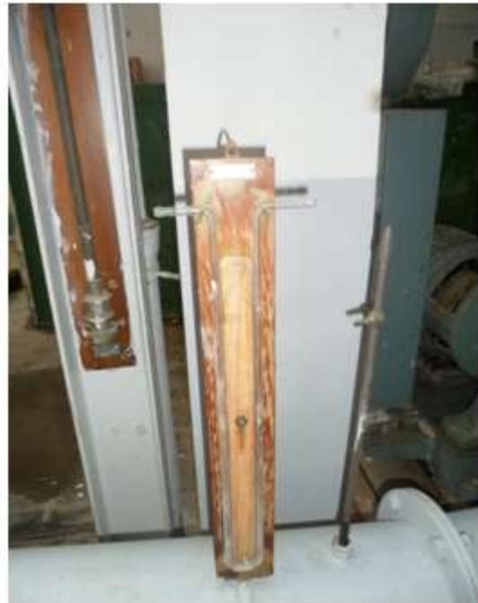
**Figure II.17 :** Les tubes en "U" utilisés sur le banc d'essai
