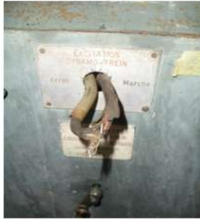
**Figure II.6 :** Interrupteur de la dynamo-frein
