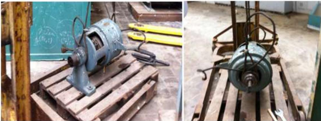
**Figure II.12** : démontage du MCC
