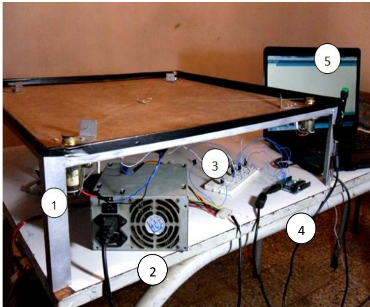
Figure (IV-6):montage final du robot à quatre câbles.
