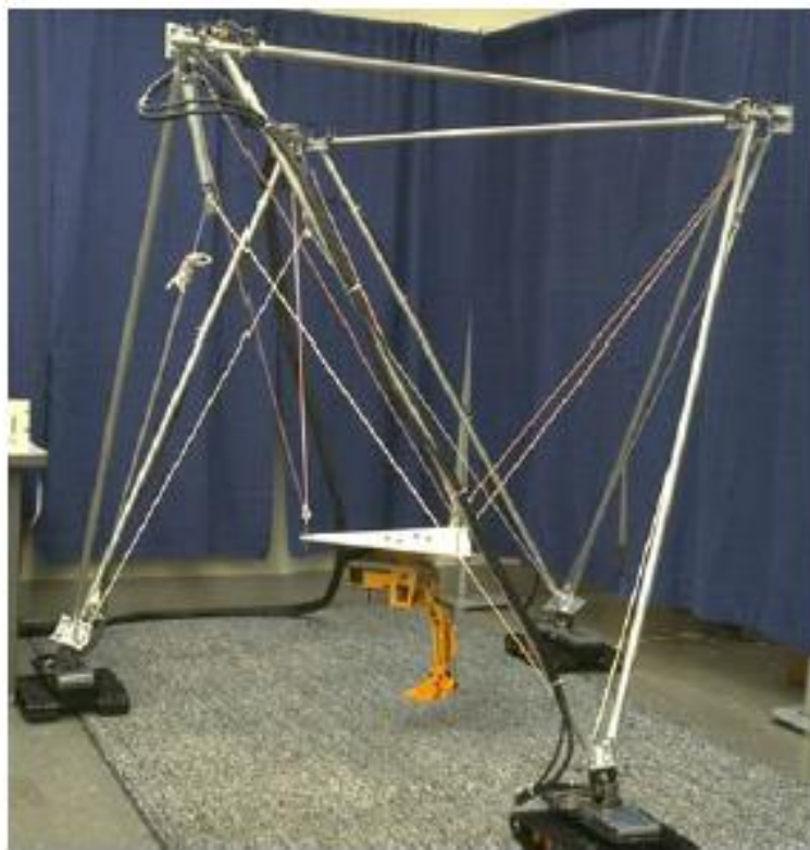
Figure (I-1) : Exemple de robot parallèle à câbles
