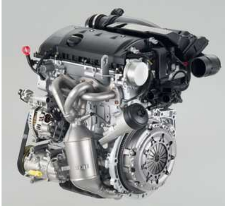
Figure V.2. Moteur de notre banc d'essai (Peugeot 308 1,6 VTi 120 cv) [26]
