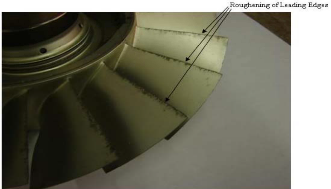
Figure III.19. Des dommages sur le bord d'un acier inoxydable (AM355) premier blisk étage du compresseur due à l'érosion de particules solides. GE série T-700 blisk n ° de série GWHTFANG.
