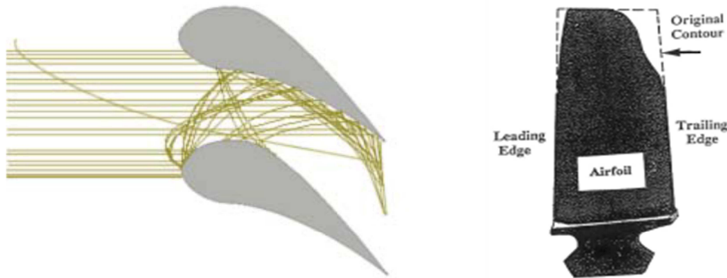
Figure III.18 Les particules de sable pénètrent vers la gauche et frappent l'aube de compresseur / turbine à différents angles. Adapté de Tabakoff.28
