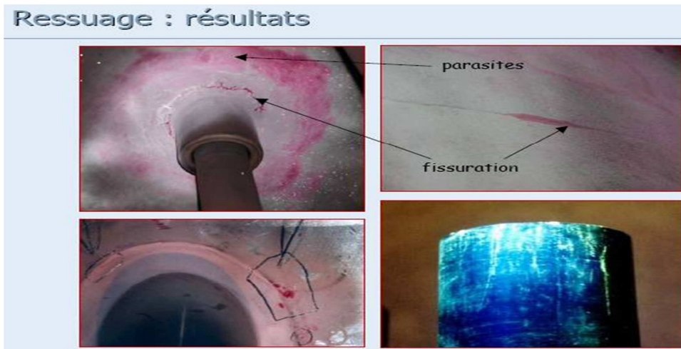
Figure IV.1 Le ressuage sur différent place dans la turbine à gaz
