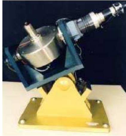
Fig I.11 : Pendule gyroskopique inversé.
