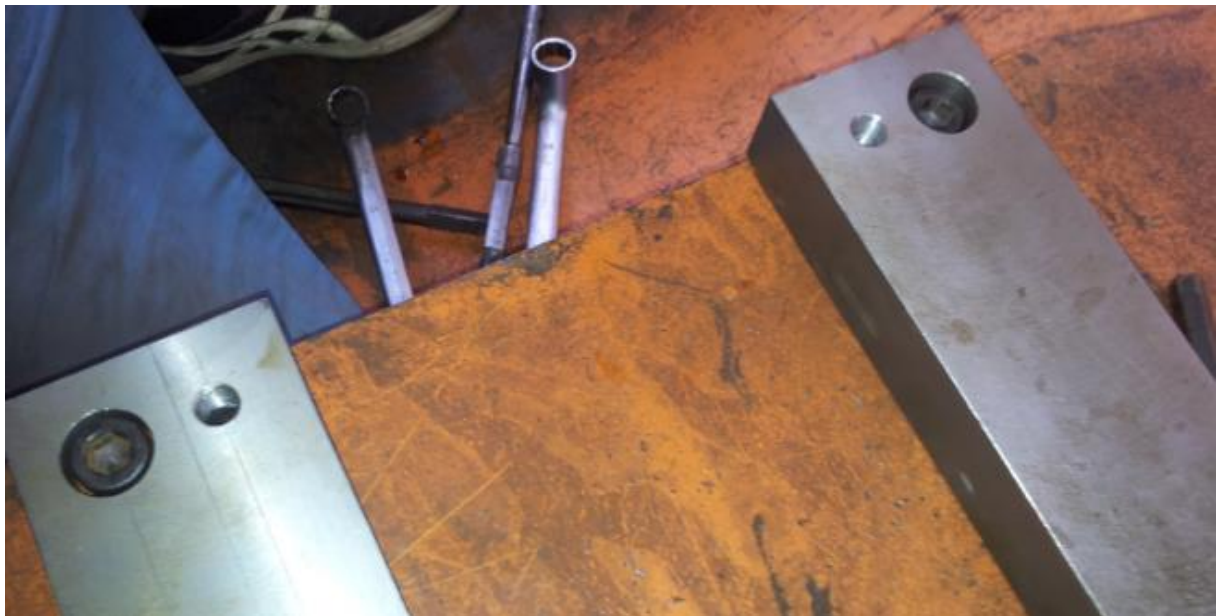
Figure V.7: Fixation des fers plats avec usage des Vis CHC m18.
