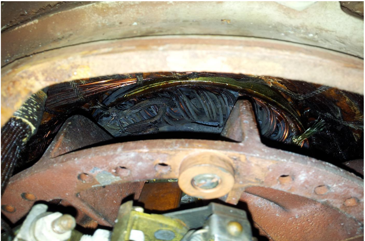
Figure.III.8: Une image montrant le bobinage grillé.
