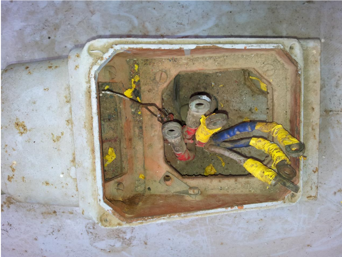
Figure.III.6 : fils rotoriques et statoriques sortant de la boite à borne du moteur
