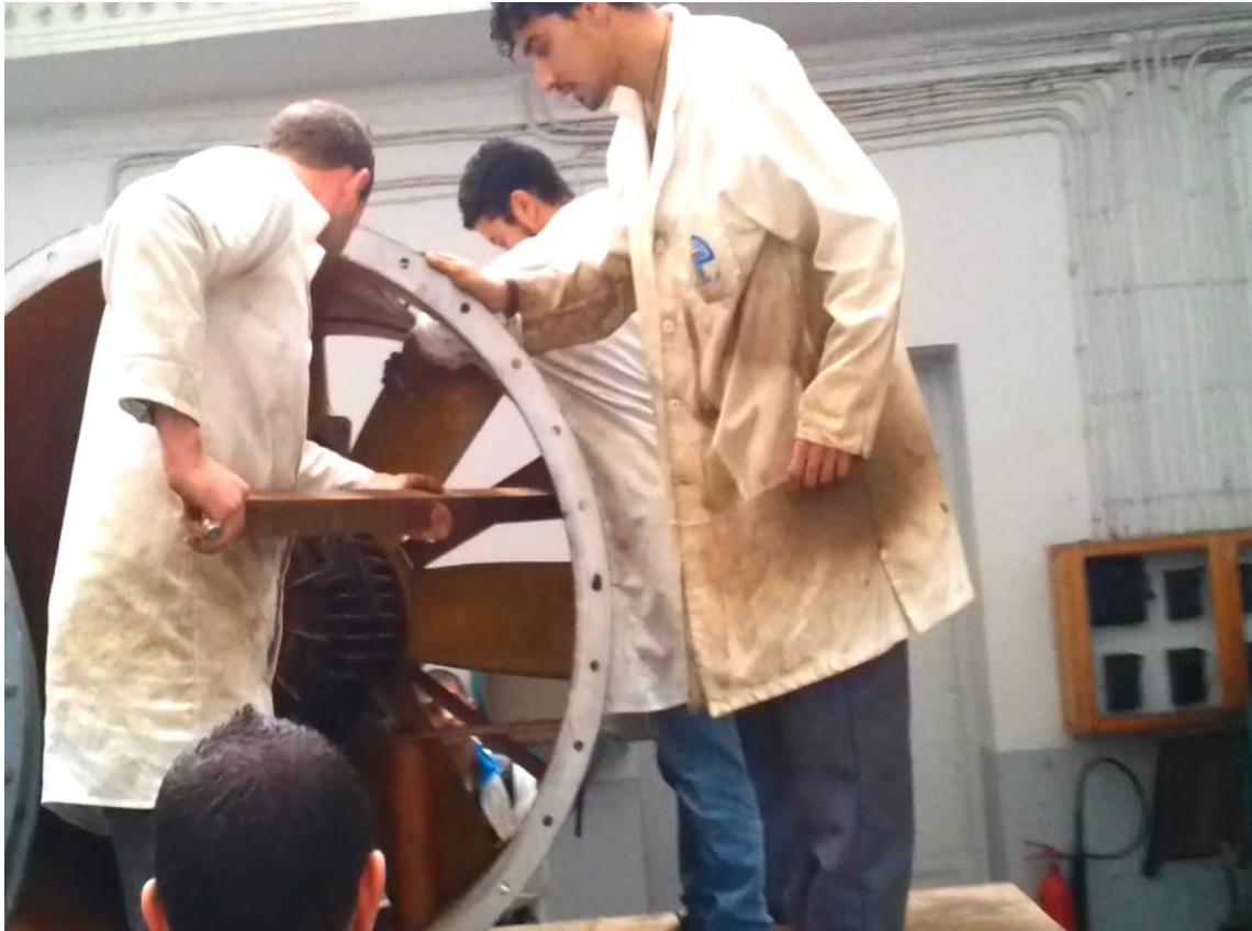
Figure.IV.10: le démontage du redresseur.
