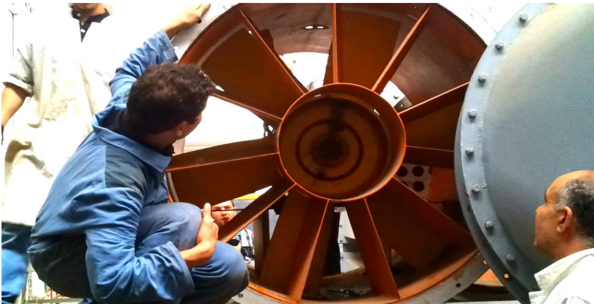
Figure.IV.9: une image montrant les différents constituants de la partie cylindrique (grille fixe-ventilateur-moteur)
