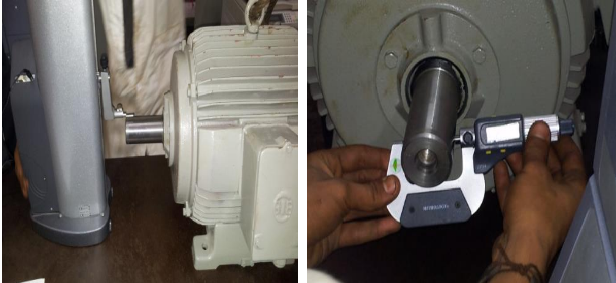
Figure V.1 : mesure des côtes du moteur dans le laboratoire de métrologie
