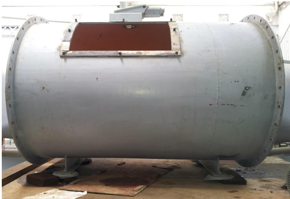
Figure.I.6: la partie cylindrique contenant le moteur
