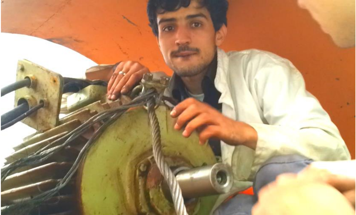
Figure.IV.13: utilisation de l'élingue comme moyen d'accrochage
