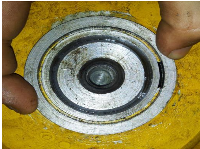
Figure V.10 : mise au point d'une petite bague pour compenser la longueur de plus sur la bague.
