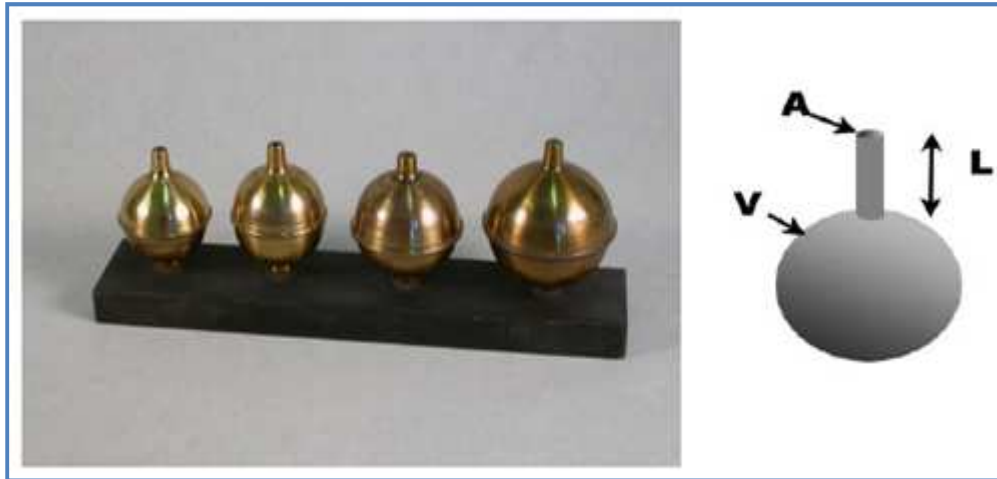
Figure III-3 Schéma d'un résonateur de Helmholtz
