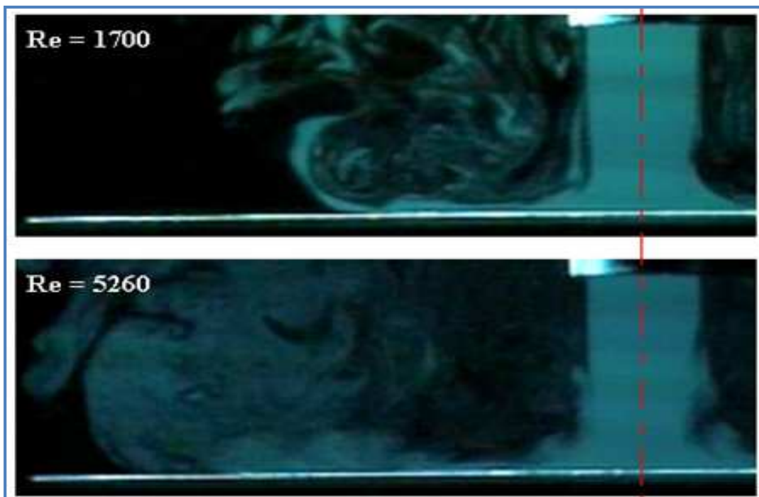
Figure IV-4 Influence du nombre de Reynolds sur la position du point de décollement
