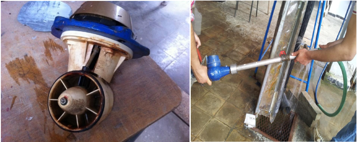
Figure II-4 : Réparation des compteurs
