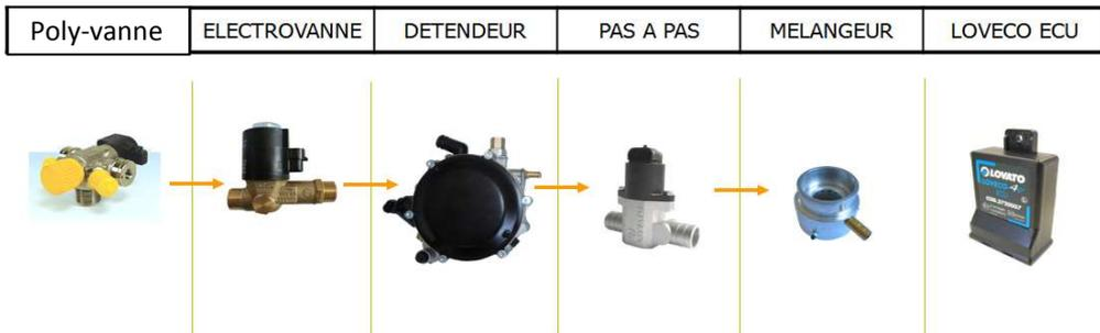
**Figure III.4: Schéma simplifié d'une installation à aspiration en boucle fermée**
