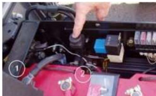
**Figure III.17** Détecteur de choc, emplacement dans le bac des batteries
