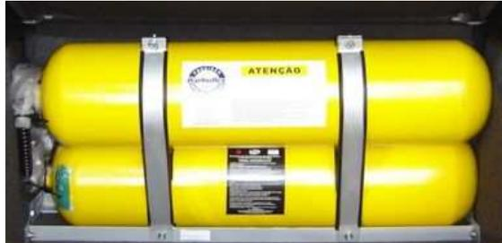
**Figure III.7 Réservoirs en acier allié**
