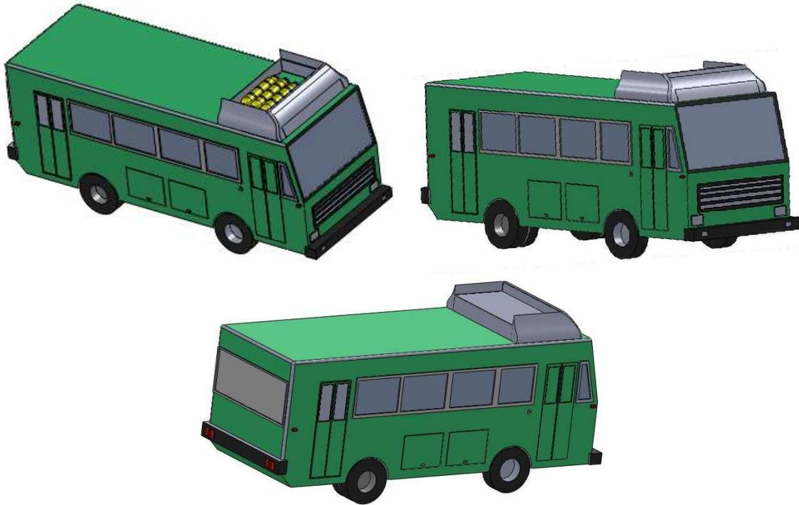
**Figure III.20. Fixation de l'ensemble bouteilles-carénage sur le bus 25L4.**
