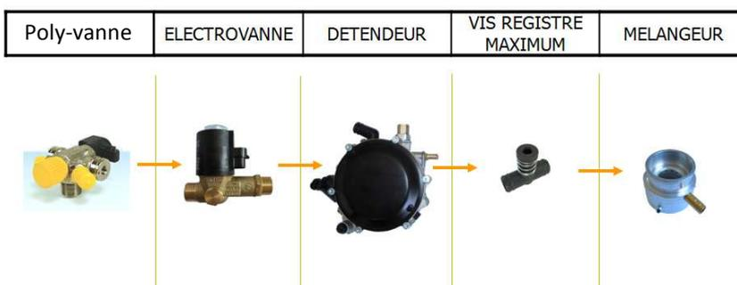
**Figure III.3: Schéma simplifié d'une installation à aspiration en boucle ouverte**
