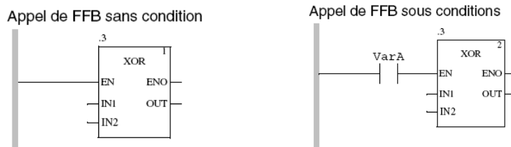
Figure II.12 : Connexion d'une FFB
