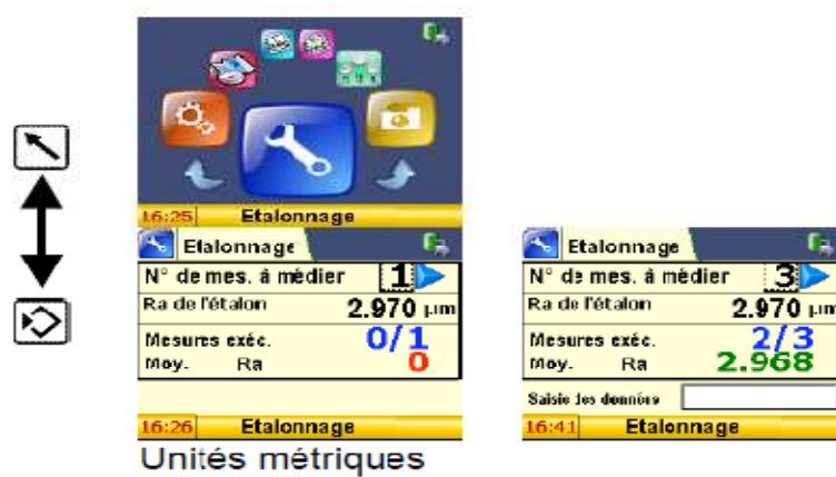
Figure (5.3) : Choix de spécimen d'étalonnage
