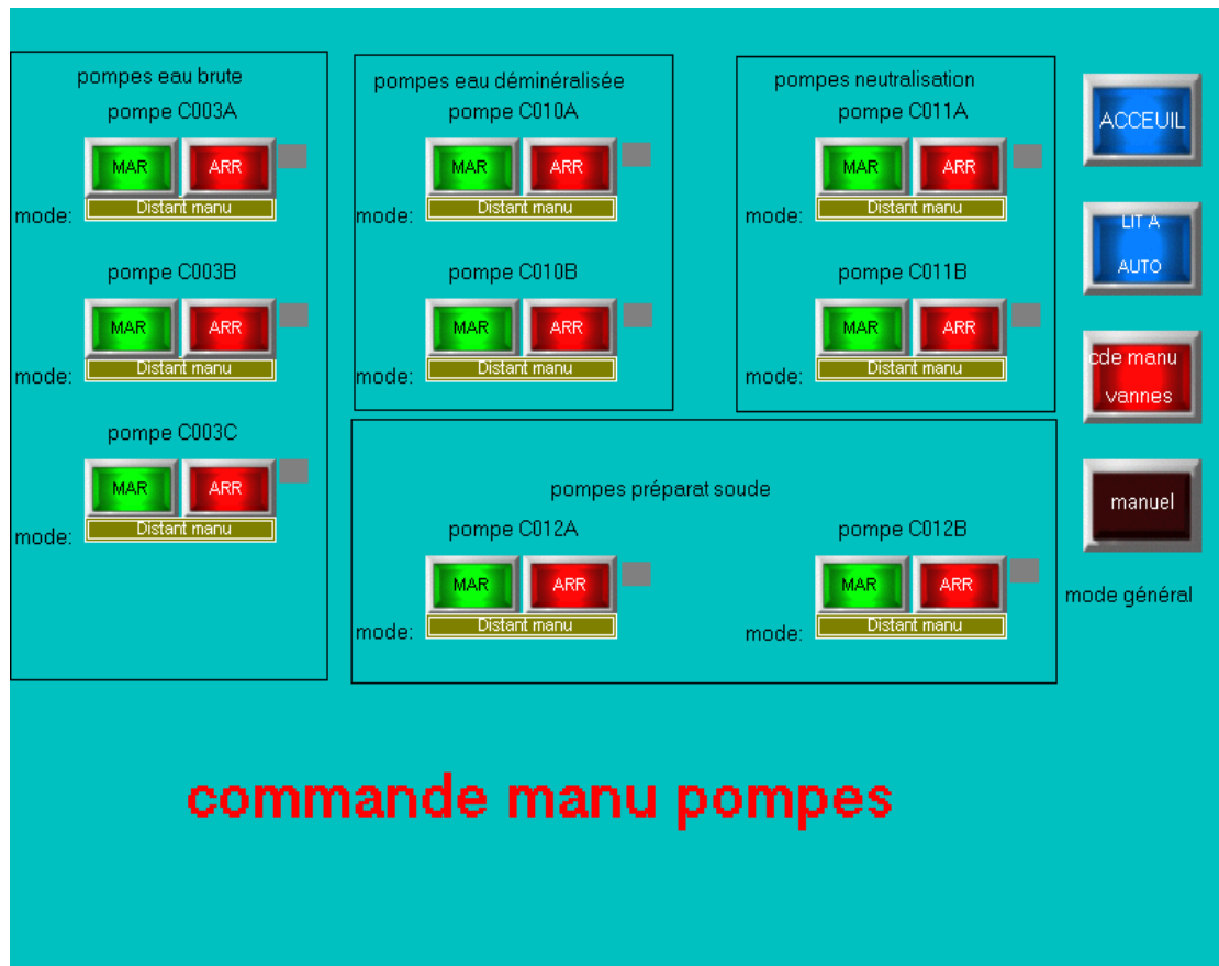
Figure IV.40 : page de supervision de la commande manuelle des pompes
