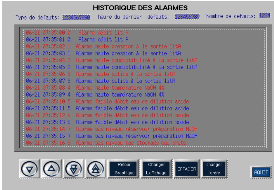
Figure IV.30 : page de supervision de l'historique des alarmes
