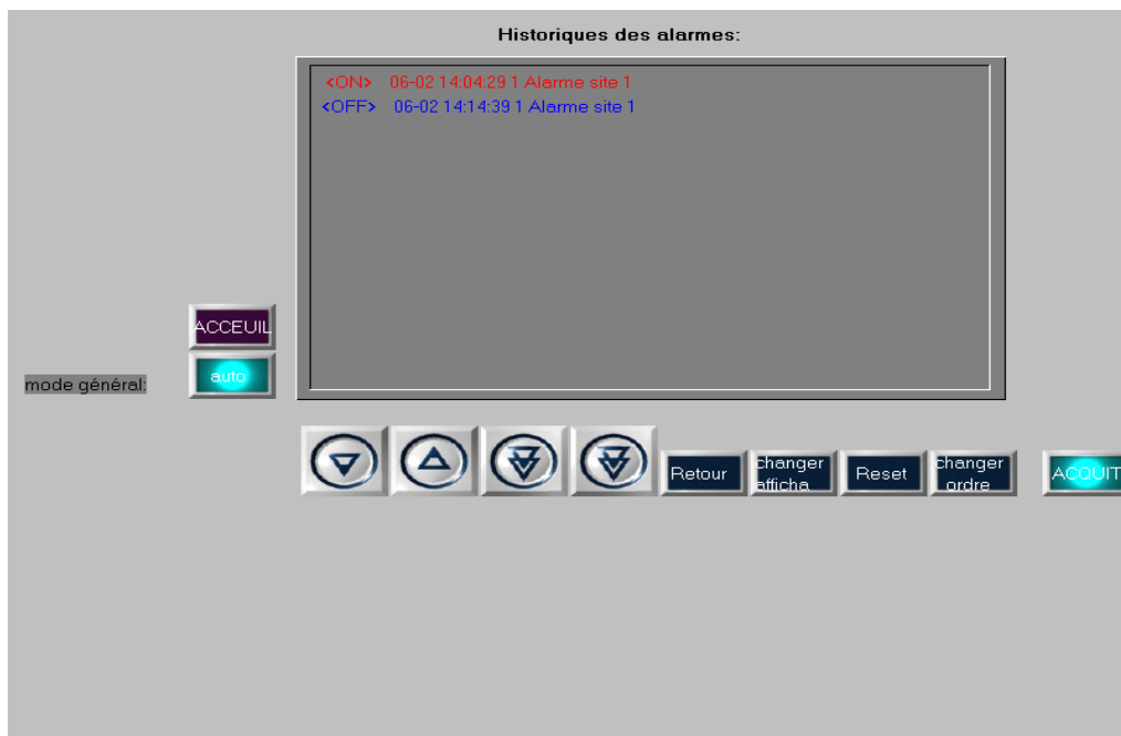
Figure IV.50: Acquittement du signal d’alarme dans l’interface de supervision
