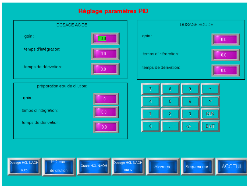
Figure IV.36 page de supervision d'introduction des paramètres du PID
