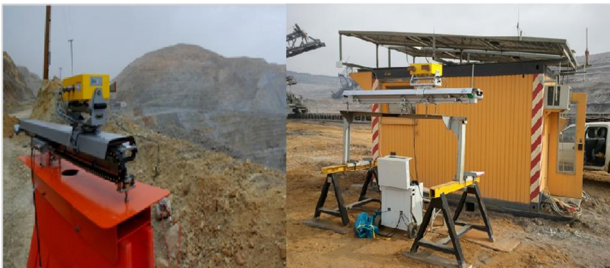
Figure 14-I: Radar positionné sur site devant un bord d'une mine à C-O et leur station de pilotage
