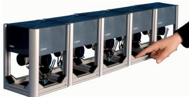
FIGURE II.3: Chaîne d'assemblage à base de micro Delta
