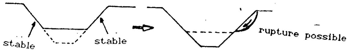
Fig 3.4: Rupture possible d'une pente au cours de l'approfondissement d'une fosse [29].
