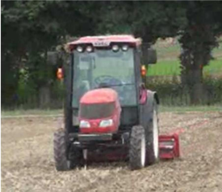
**Figure 1.2. Tracteur autonome à base de Yanmar EG65**
