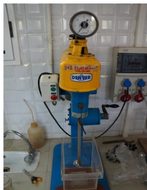
Figure 41 : cellule de flottation
