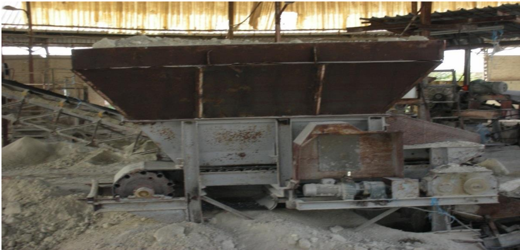
Trémie d'alimentation avec alimentateur à vitesse variable
