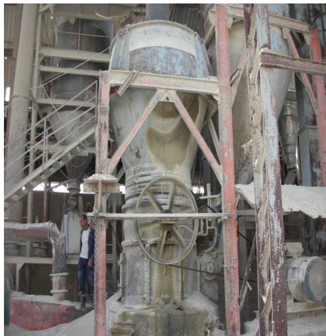
Broyeur pendulaire équipé de trois pendules avec socs et un système de lubrification.
