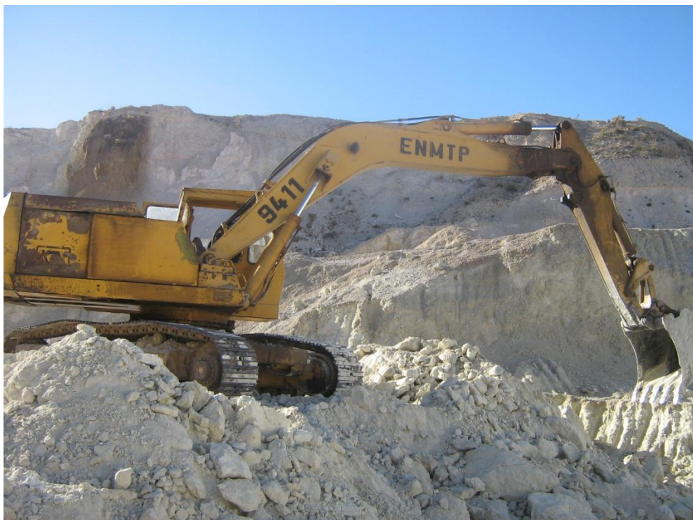
Figure .II. 6: Extraction bentonite et chargement tout-venant (carrière Roussel I).
