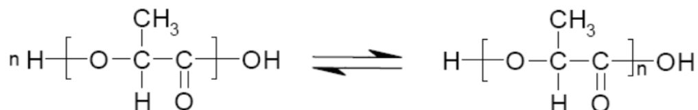
Figure I.4 : Réaction de polycondensation d'acide lactique en acide poly lactique.
