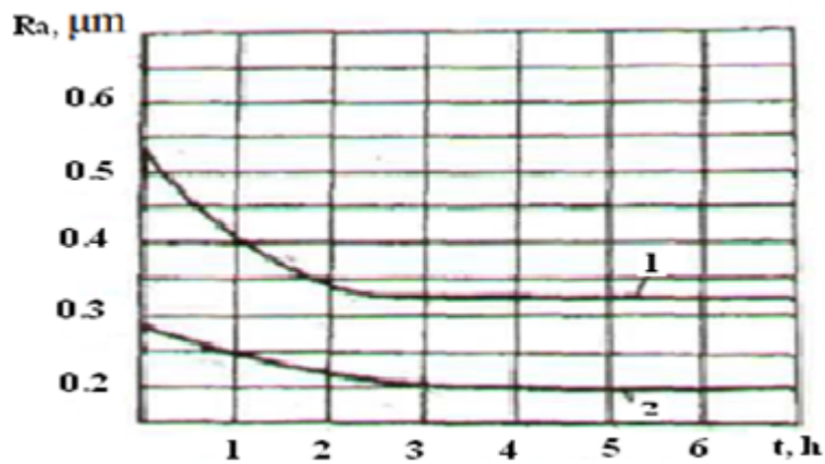
Fig. 2. 10. L'influence de la durée du traitement sur la rugosité d'échantillons en acier :
