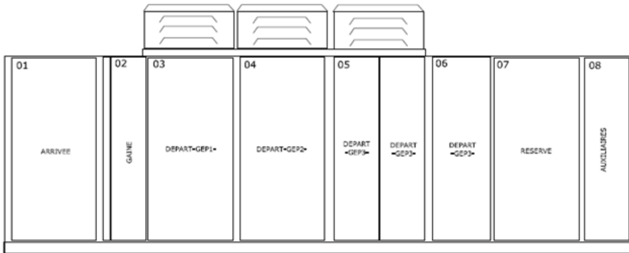
Figure III.1 Vue de face avant du tableau basse tension [1]
