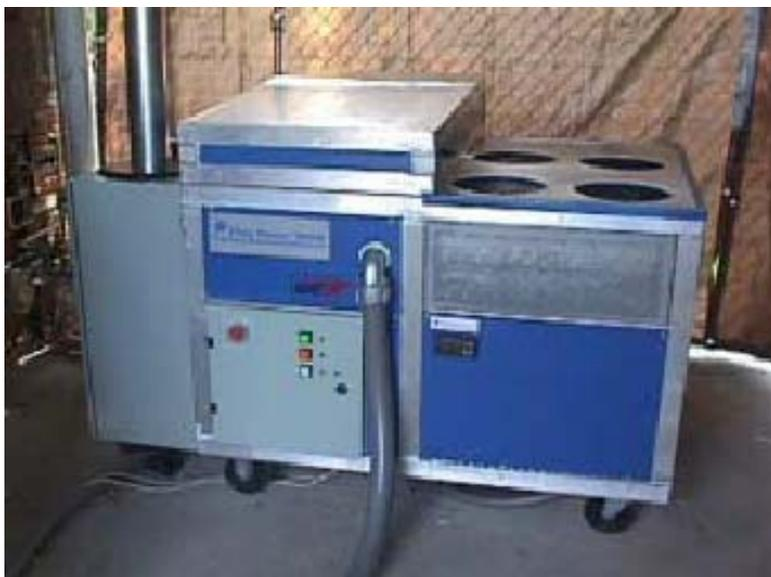
Figure 1.2 : Photo d'une PEMFC de 7kWe pour application résidentiel [9]
