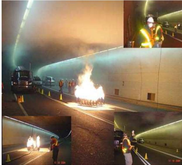
Fig.2.10 Les essais d'incendie faits au tunnel de L.H. la fontaine (Canada)
