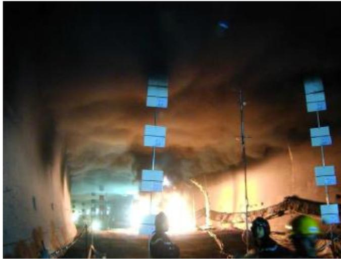
Fig.1.2 Propagation de fumées dans un tunnel routier [2].
