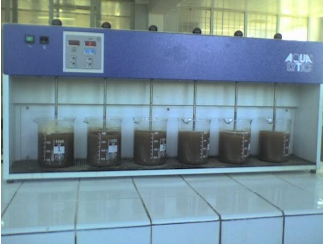
Figure 2.5: Photo illustrant l'essai de coagulation sur jar-test
