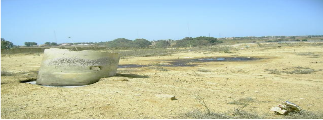
Figure 2.2 : Point de prélèvement P1 (drain du biogaz, casier 1)
