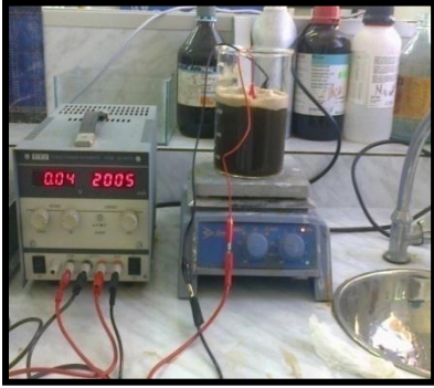
Figure 2.8 Dispositif expérimental pour l'électro-Fenton
