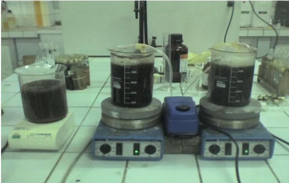
Figure 2.6 : Installation de traitement biologique par boues activées
