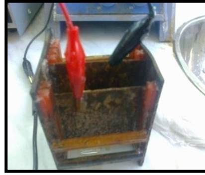
Figure 2.9 : Cellule d'électro-Fenton (Anode + Cathode en fer)
